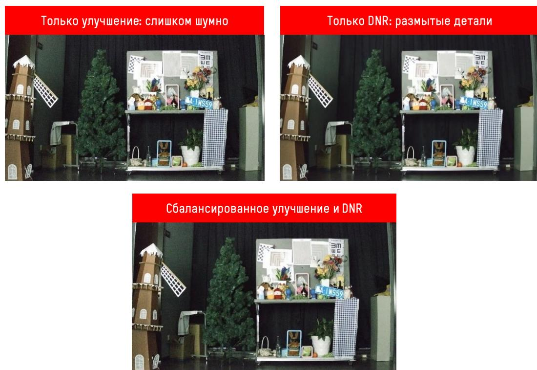
Рисунок 11 Сравнение различных параметров настройки изображения
