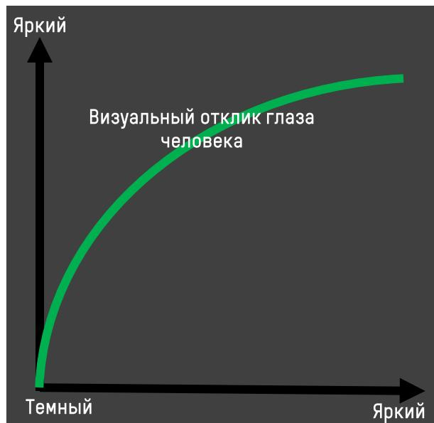
Рисунок 8 Нелинейный визуальный отклик глаза человека на свет
