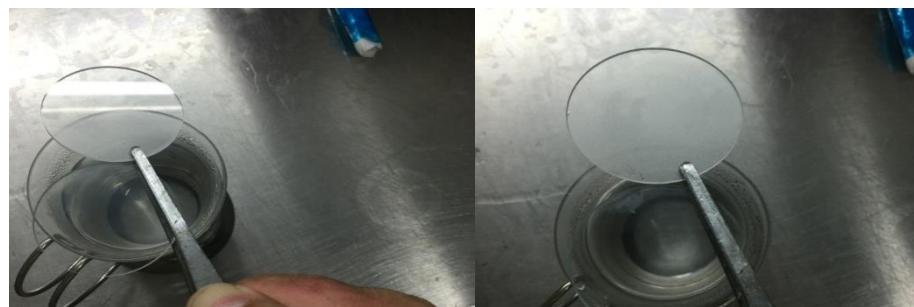
Рисунок 14 Результаты тестирования антизапотевающего стекла (слева) и обычного стекла (справа)
