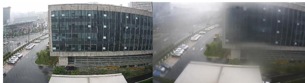
Рисунок 15 Изображение камеры с антизапотевающим стеклом (слева) и обычным стеклом (справа)
