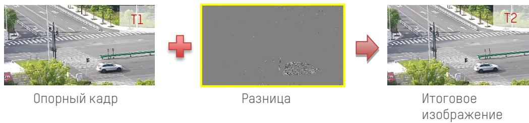
*Рисунок 3 Традиционная схема кодирования с опорным кадром*
