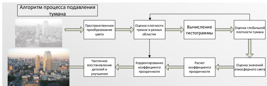
Рисунок 1 Блок-схема процесса функции антитуман
