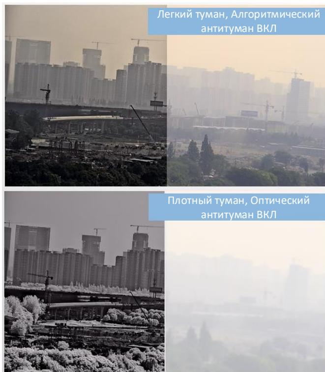
Рисунок 5 Результат работы функции антитуман при различной плотности тумана
