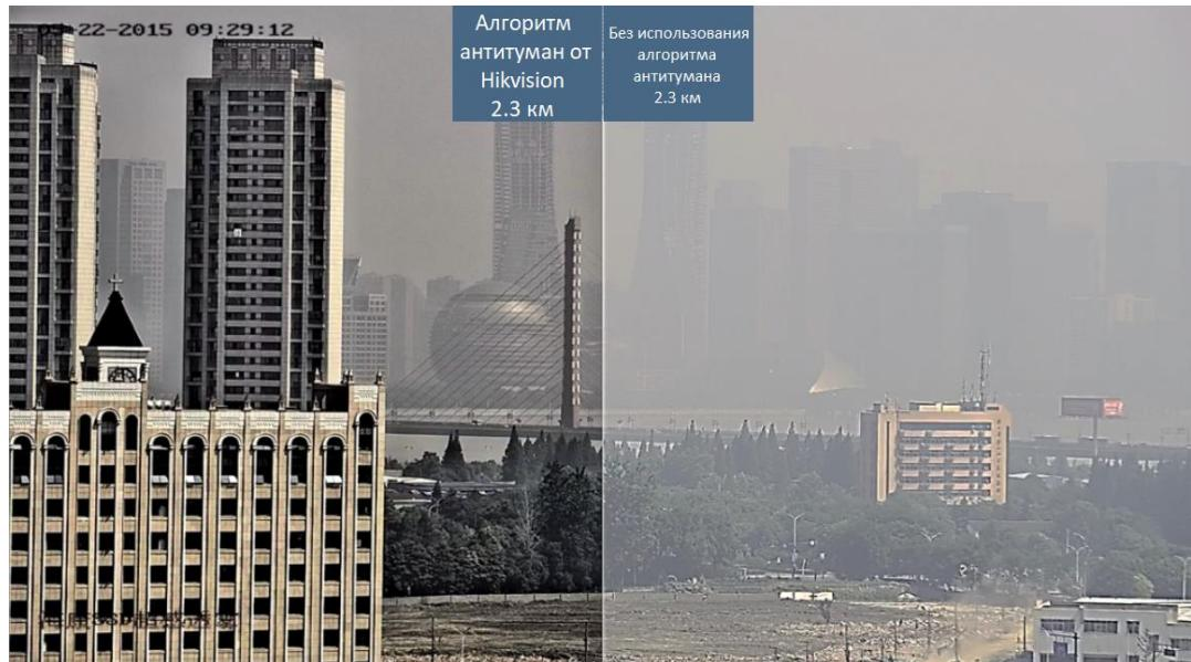
Рисунок 2 Подавление тумана на большом расстоянии при помощи алгоритмической технологии антитуман от Hikvision
